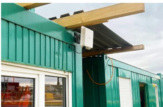
possible de fixer l'appareil soit sur un mur, soit sur un poteau. Grâce au support PoE (Power-over-Ethernet) intégré, même l'alimentation électrique ne pose plus de problème.
