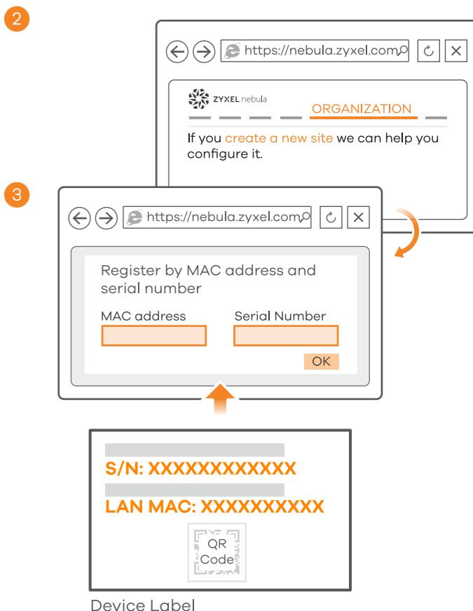
**IT** ④ Seguire la procedura seguente per gestire il WAC5302D-Sv2 attraverso il sistema di gestione della rete basato su cloud Zyxel.**Nota:** Assicurarsi che il router connesso disponga di un accesso a Internet.
