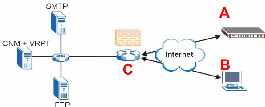
Если сервер Vantage CNM находится за межсетевым экраном, необходимо настроить его правила для свободного прохождения трафика между Vantage CNM и устройствами ZyXEL. Кроме того, нужно настроить перенаправление портов NAT, чтобы обеспечить перенаправление следующих видов трафика на Vantage CNM через указанные порты:
