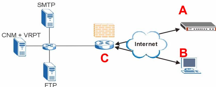
Si el Vantage CNM está detrás de un cortafuegos, debe configurar las reglas del cortafuegos para permitir que el tráfico fluya hacia/desde el Vantage CNM a los dispositivos ZyXEL. También debe configurar el reenvío de puertos NAT para permitir al siguiente tráfico que sea reenviado al Vantage CNM a través de los siguientes puertos:
