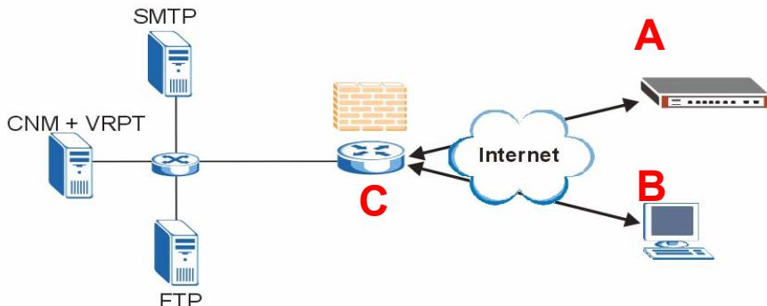
Si Vantage CNM se trouve derrière un pare feu, vous devez installer les règles de pare feu afin de permettre au trafic de circuler vers/à partir de Vantage CNM vers les périphériques ZyXEL. Vous devez aussi configurer le réacheminement de port NAT afin de permettre au trafic suivant d'être réacheminé vers Vantage CNM via les ports suivants :
