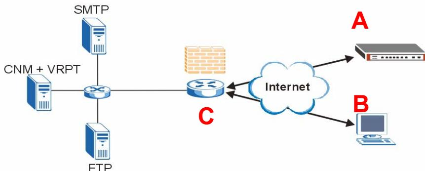
Wenn sich Vantage CNM hinter einer Firewall befindet, müssen Sie Firewall-Regeln festlegen, damit der Datenverkehr vom/zum CNM zu den ZyXEL-Geräten fließen kann. Sie müssen außerdem NAT Port Forwarding konfigurieren, damit der Datenverkehr über die folgenden Ports zum Vantage CNM weitergeleitet wird:
