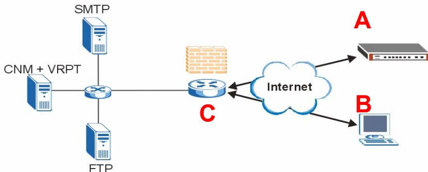
如果 Vantage CNM 位在防火牆之後，您必須設定防火牆規則，以讓傳輸流量流至 Vantage CNM 或從 Vantage CNM 流至 ZyXEL 裝置。此外，也必須設定 NAT 埠轉遞功能，以讓下列傳輸流量透過下列埠轉遞至 Vantage CNM：
