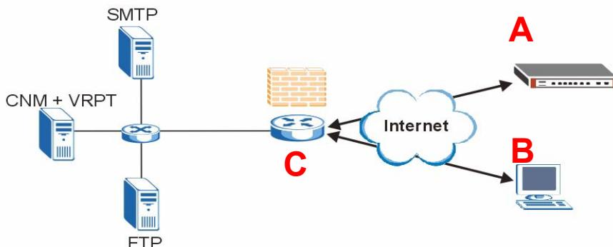
Se Vantage CNM si trova dietro un firewall, è necessario configurare regole di firewall per permettere al traffico di fluire verso/da Vantage CNM verso i dispositivi ZyXEL. È inoltre necessario configurare il port forwarding NAT per consentire l'inoltro del traffico seguente al Vantage CNM tramite le porte seguenti:
