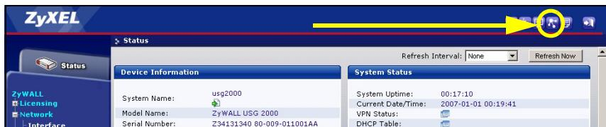
Utilice el asistente para la instalación para conectarse a Internet y registrar el ZyWALL y/o activar los servicios de prueba, como IDP y el filtro de contenidos.
