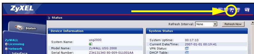
Utilizzare la configurazione guidata per connettersi a Internet e registrare il ZyWALL e/o attivare i servizi offerti per valutazione, come ad esempio IDP e il filtraggio dei contenuti.
