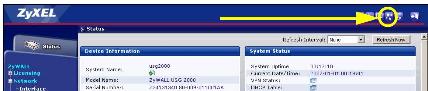
Мастер первоначальной настройки Installation Setup Wizard служит для подключения к Интернету и регистрации устройства ZyWALL и/или активации пробного периода доступа к дополнительным сервисам, таким как служба обнаружения и предотвращения вторжений или фильтр контента.
