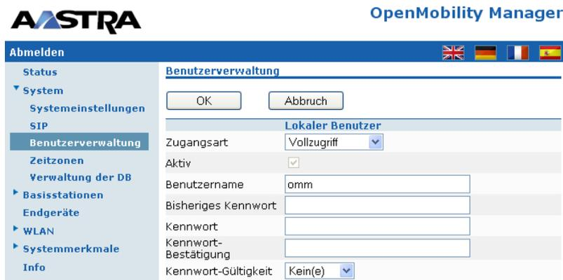
Zur Änderung des Passworts muss das alte Passwort wieder eingegeben werden. Das OMM verfügt über verschiedene Regeln zur Prüfung der Komplexität eines neuen Passworts, somit wird ein neues Passwort nicht akzeptiert, wenn irgendeine dieser Regeln verletzt wird.
