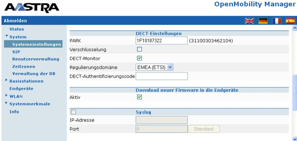
**Hinweis:** Das markierte Kontrollkästchen DECT Monitor wird aus Sicherheitsgründen nicht dauerhaft im integrierten Flash-Speicher des OMM/RFP gespeichert. Das markierte Kontrollkästchen DECT-Monitor wird beim Rücksetzen gelöscht.
