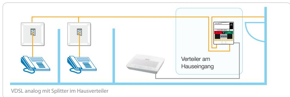
VDSL analog mit Splitter im Hausverteiler
