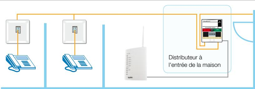
VDSL analogique avec splitter dans le distributeur domestique
