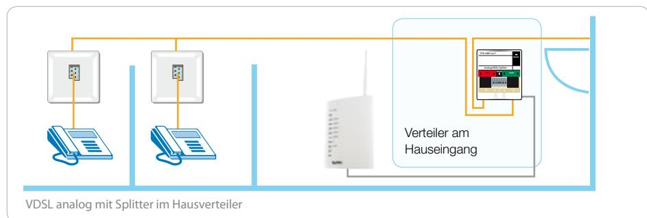
1. Der Analog-Splitter wird im Verteiler zwischen Hauszuführung und Telefonzuleitungen eingeschleift. Der Splitter kann geöffnet und der Installationsdraht direkt an den entsprechenden Klemmen angeschlossen werden.
