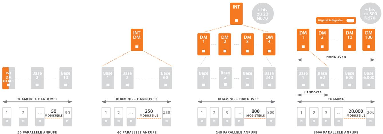
Eine Hardware für alle Funktionen: N870 IP PRO. Funktion wird durch Rollen in den Geräteeinstellungen festgelegt: Integrator, DECT-Manager und/oder Basisstation.
