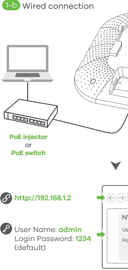
**SE** **1-b** Använd en Ethernet-kabel för att ansluta en dator till NWA210AX **UPLINK-port** via en PoE-injektor eller PoE-omkopplare. Använd den DHCP-tilldelade IP- eller statiska IP-standardadressen "http://192.168.1.2" för att öppna webbkonfiguratorn. Kontrollera att datorns IP-adress finns i samma delnät som NWA210AX.
