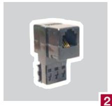
Das hochfrequente ADSL-Signal und ein analoges Endgerät stören sich gegenseitig. Vor jedem Telefon oder Faxgerät muss deshalb ein ADSL-Filter eingesetzt werden. Bei Bedarf sind weitere Filter im Fachhandel erhältlich.
